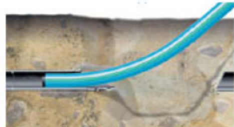
Релайнинг (протаскивание трубы в трубу)
