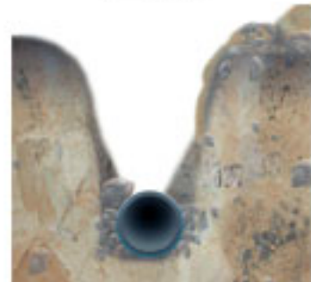
Траншейная укладка без песчаной засыпки
